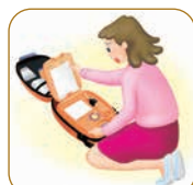
Step 1 フタを開けると電源ON
